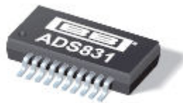
Fig. 6.2. Detall de l'encapsulat del convertidor
